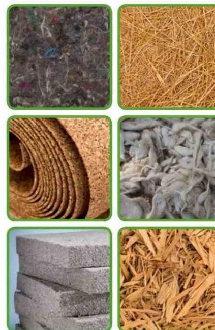
Exemples de matériaux biosourcés : textile recyclé, paille, liège, laine, cellulose, bois...
