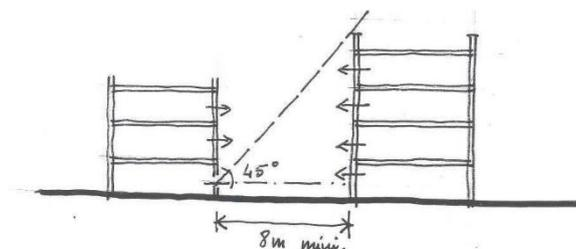
Les constructions ne comportant pas de logements situées en vis-à-vis doivent être implantées de manière que les vues directes ne soient masquées par aucune partie d'immeubles qui à l'appui de ces baies serait vue sous un angle de plus de  $65^\circ$  au-dessus du plan horizontal, avec un minimum de 6 m.
