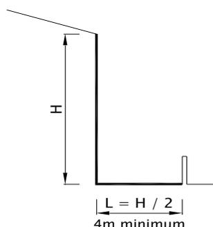
En cas d'implantation sur la limite séparative ou de fond, la construction doit présenter des murs aveugles.
