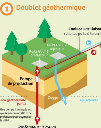
Un doublet est constitué d'un puits de production qui capte l'eau chaude naturellement présente dans le sous-sol (59 °C à 1 570 m à Villetteuse) et d'un puits de réinjection qui assure le retour de l'eau refroidie dans le réservoir. Ces deux puits sont distants, en profondeur, d'au moins 1 500 m, afin d'éviter de pomper au niveau du puits de production l'eau froide réinjectée.
